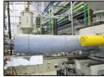
รูปที่ ๓-๒ ติดตั้งฉนวนกันความร้อนหุ้มท่อเครื่องฉีดพลาสติก
