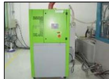
รูปที่ ๓-๑ ติดตั้งเครื่องลดความชื้นในอากาศ (Mold Sweat Dehumidifier) ที่เครื่องเป่าพลาสติก
