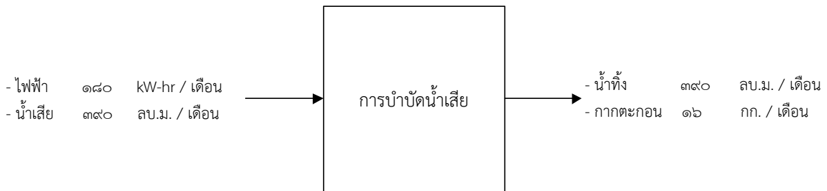
รูปที่ ๒-๒๐ สมดุลมวลของกระบวนการบำบัดน้ำเสีย
